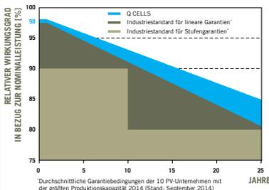
Mindestens 98% der Nennleistung innerhalb des ersten Jahres. Danach max. 0,54% Degradation pro Jahr. Mindestens 93,1% der Nennleistung nach 10 Jahren. Mindestens 85% der Nennleistung nach 25 Jahren.
