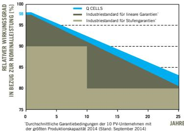
Mindestens 98% der Nennleistung innerhalb des ersten Jahres. Danach max. 0,6% Degradation pro Jahr. Mindestens 92,6% der Nennleistung nach 10 Jahren. Mindestens 83,6% der Nennleistung nach 25 Jahren.
